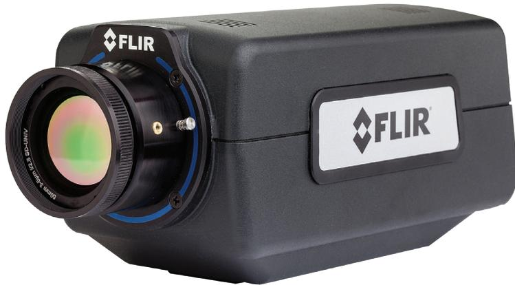
FLIR A6750 SLS长波热像仪配备制冷型应变层超晶格(SLS)探测器,工作波长范围覆盖7.5到10.5微米,能生成640x512像素分辨率的清晰热图像。在窗口模式下最高采集帧速高达4.1KHz,并且可以和其他设备进行同步,确保不会丢失任何数据。
